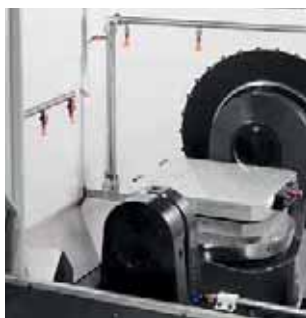
System sputkiwania wiórów
