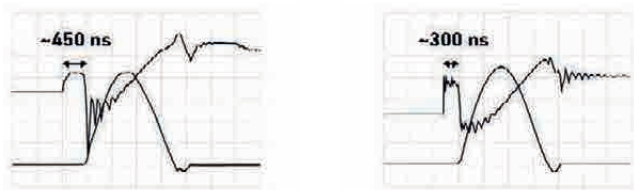
Proudový a napěťový diagram procesu elektroeroze ukazuje vyšší reaktivitu generátoru IPG-DPS.
