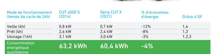
Mesures effectuées sur le système CUT X 500 conformément aux normes de mesure définies dans la norme ISO 14955
